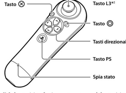
\* La levetta sinistra funziona esattamente come la levetta sinistra del controller wireless DUALSHOCK®3.
