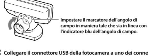
**2 Collegare il connettore USB della fotocamera a uno dei connettori USB del sistema PS3™.****3 Posizionare la fotocamera al centro rispetto allo schermo della TV.**
