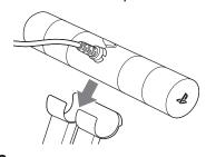
2 Alinhe as ranhuras na base do cabo com o suporte e pressione a base do cabo no suporte.
